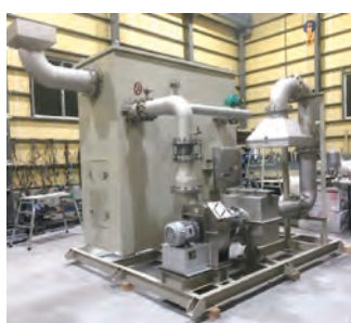
制作された燃焼設備の例
